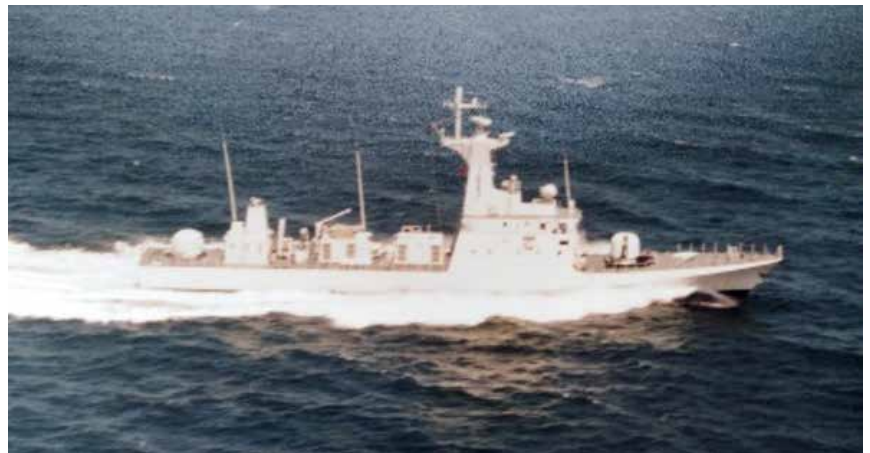
Yeni tip hücumbot 535 ton deplasman ağırlığında ve 55 knot üzerinde yüksek hıza sahip olacak.
